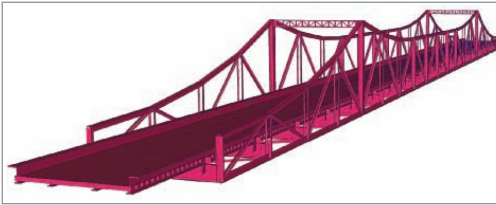
3. ábra: A híd szerkezet végelemek modellje az Axis VM programban
